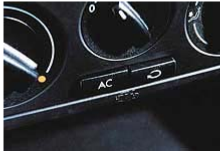
Eine eingeschaltete Klimaanlage sorgt in der Regel für einen Mehrverbrauch von einem Liter.
