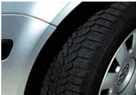
Leichtlaufreifen haben einen geringeren Rollwiderstand und helfen Sprit sparen
