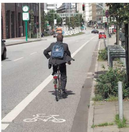
◀ **Radfahrstreifen** sind mit durchgezogener Linie, **Schutzstreifen** ▶ mit unterbrochener Linie von der Fahrbahn abgetrennt und mit Piktogramm und Radwegschild versehen.
