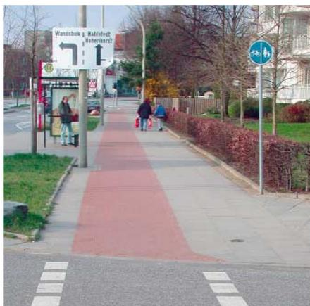
◀ **Ein getrennter Rad- und Fußweg** wird durch ein Schild und die rote Pflasterung markiert.
