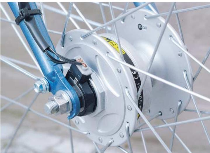
▲ Spannungsquelle Nabendynamo: Läuft unbemerkt die ganze Zeit mit – da ist man immer auf der sicheren Seite.
